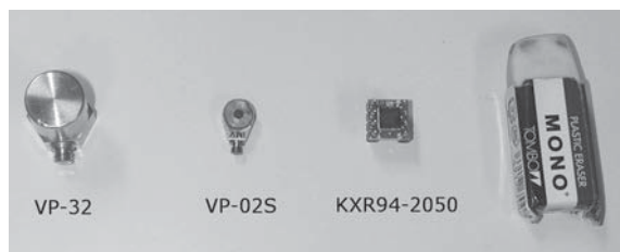
図2 加速度センサ
