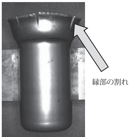
図3 3工程での縁部の割れ
