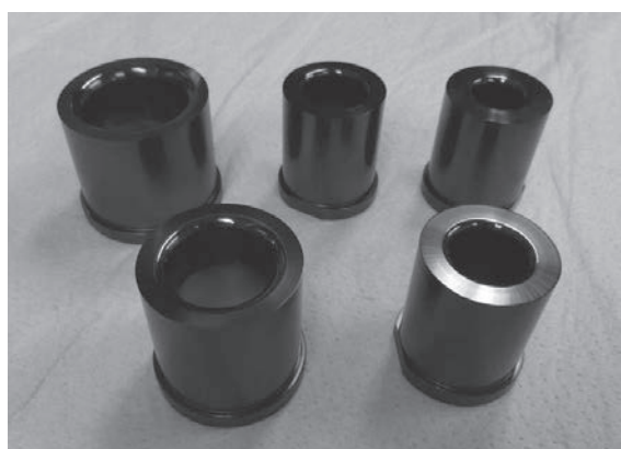
図 7 DLC 膜をコーティングしたプレス金型
