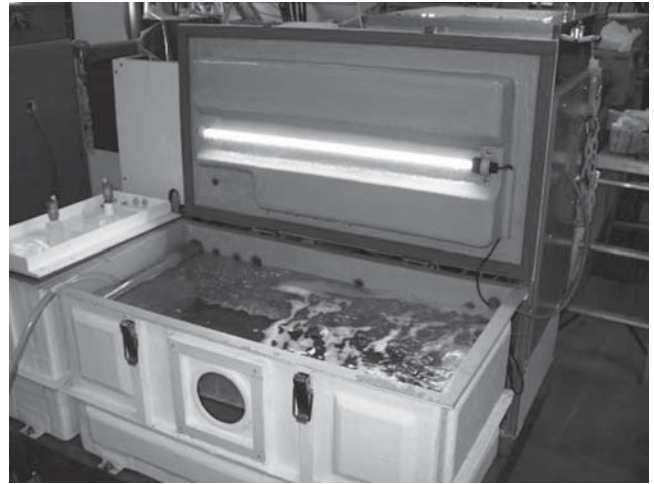
図1 活魚輸送装置（試作機）の外観
