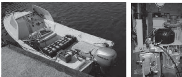
図5 エンジン式船外機の モータアシストシステム
