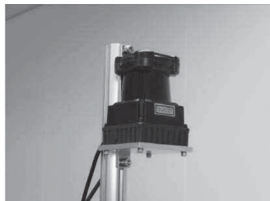
図1 固定型レーザー位置センサシステム
