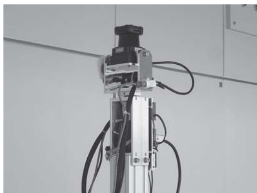
図1 レーザー位置センサシステム
