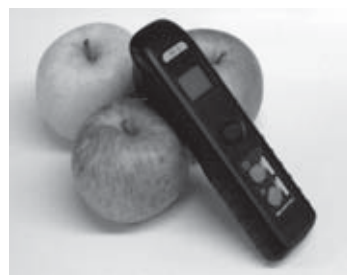
図1 TFDRSをベースに商品化した携帯型の非破壊糖度計。光源に発光ダイオードを使用し、重量200gと世界最軽量を実現した。
