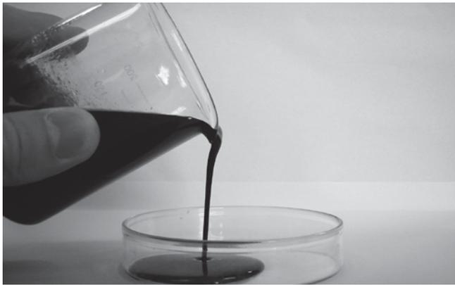
図1 液化木材の性状 (Phenol/Wood=2/1, Temp.=250°C)
