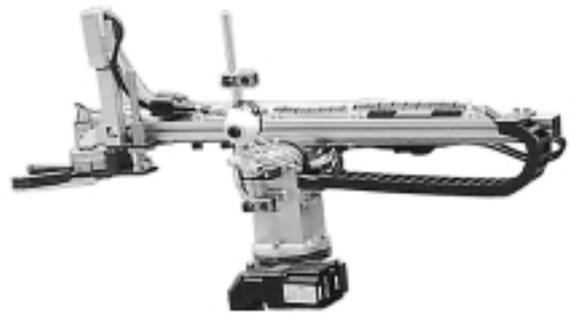
Fig 9 収穫用マニピュレータ写真
