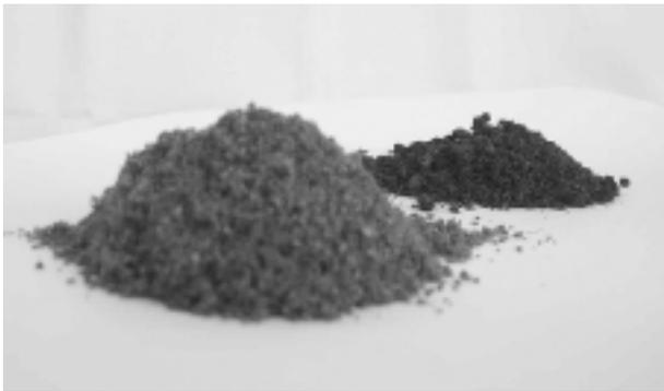
図1 部分的に液化した木材の性状 (Phenol/Wood=1/1, Temp. =175°C (左前) 225°C (右奥))
