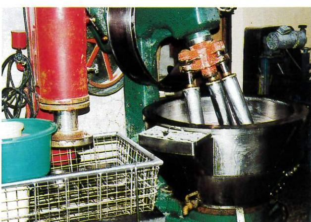
図6 加圧式脱水機・擂潰機
