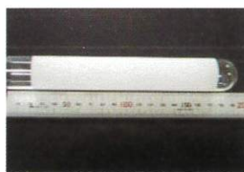
「ガラス表面への光触媒被覆」
