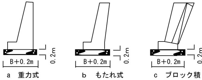
(10) 擁壁工の埋戻しについては、下図の斜線部について締固めを行う。
