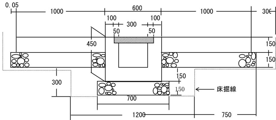
現場打横断溝は鉄筋を配置するものとする。(T-25)
