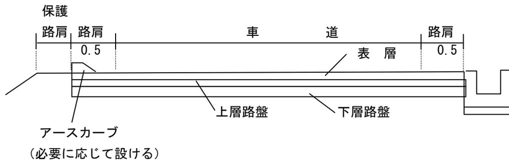
(3) 盛土内への地表水の流入を防止する必要がある場合は、舗装止のかき上げ、または、アスカーブを設置することができる。なお、舗装止、アスカーブの構造は、次を標準とする。
