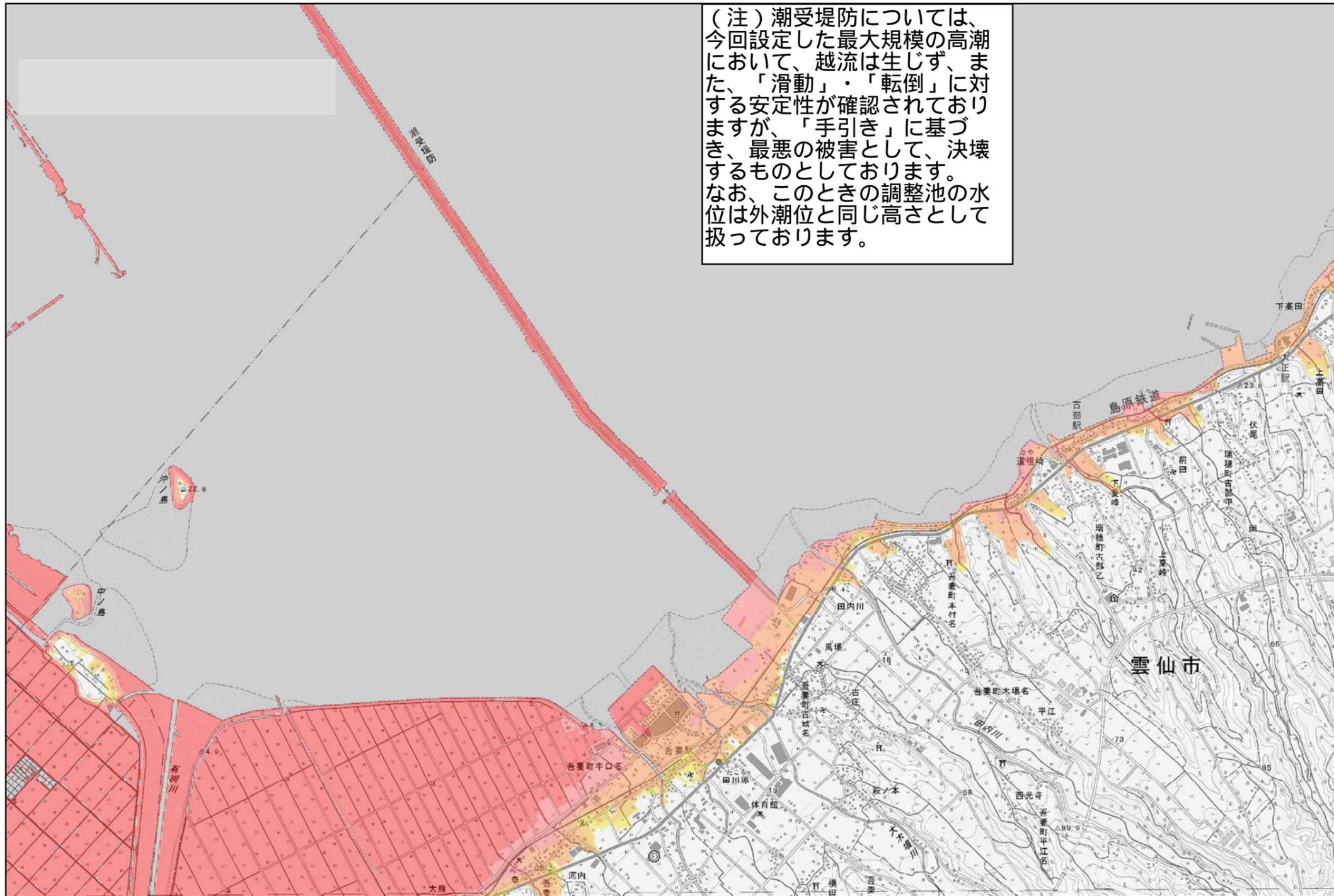
(注) 潮受堤防については、今回設定した最大規模の高潮において、越流は生じず、また、「滑動」・「転倒」に対する安定性が確認されておりますが、「手引き」に基づき、最悪の被害として、決壊するものとしております。なお、このときの調整池の水位は外潮位と同じ高さとして扱っております。
