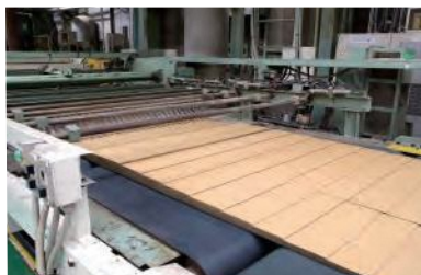
工場での段ボールの製造過程
