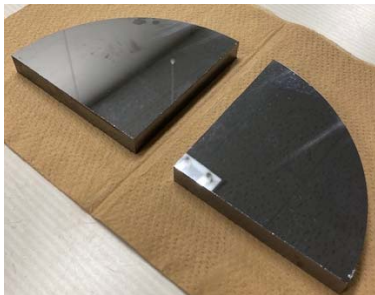
センターで実施した非金属脆性材料の切断テストおよび鏡面研磨テスト
