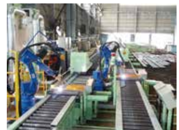
自動鋼材溶断ロボット開発テスト
