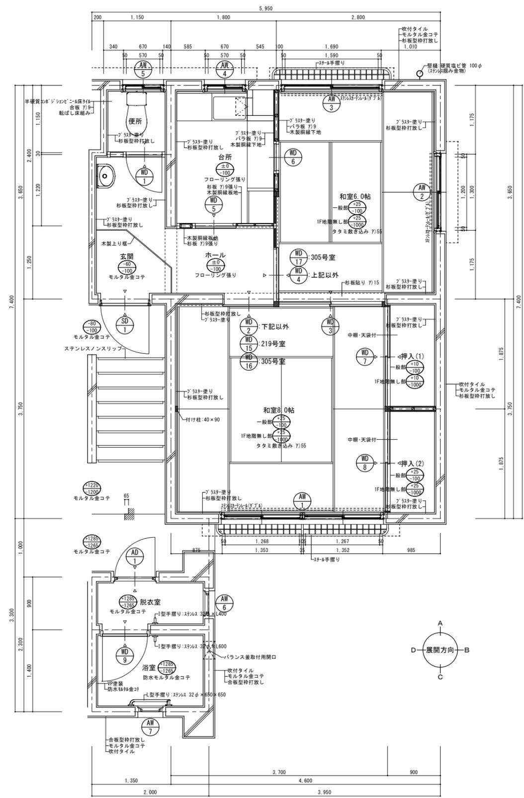
図中、室内壁部に、----- 記載部分は「合板壁増し張り有り」を示す。
