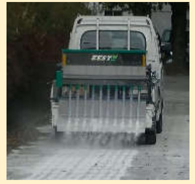
消石灰散布機による石灰散布
