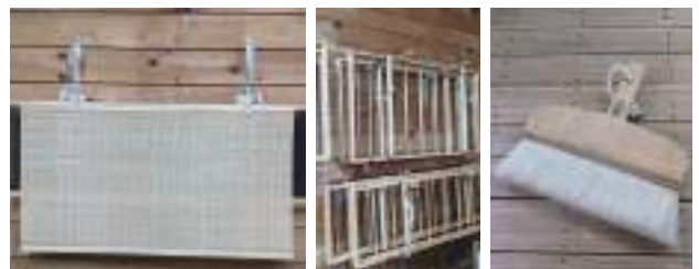
紙漉き道具 全て職人が手掛けた一点もの 左から「す」「けた」馬の尾の毛で出来た「刷毛」
