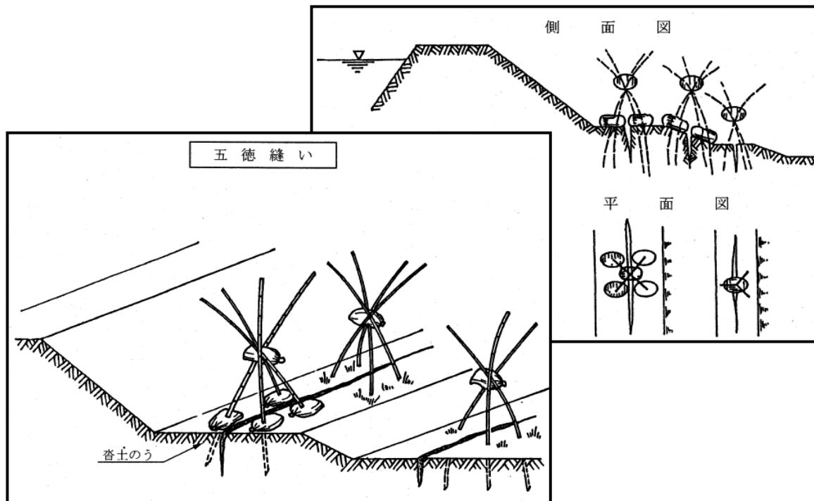
目的：川裏き裂、崩壊の拡大防止。
