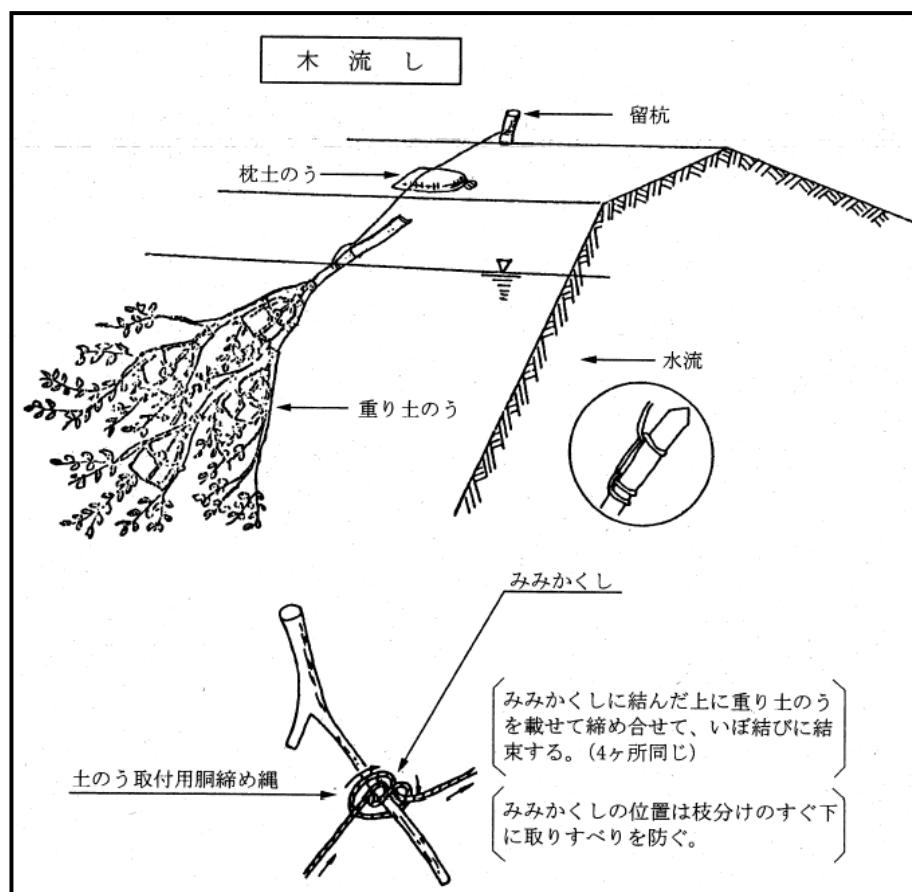
目的：急流部において流水を緩和して川表堤腹崩壊
