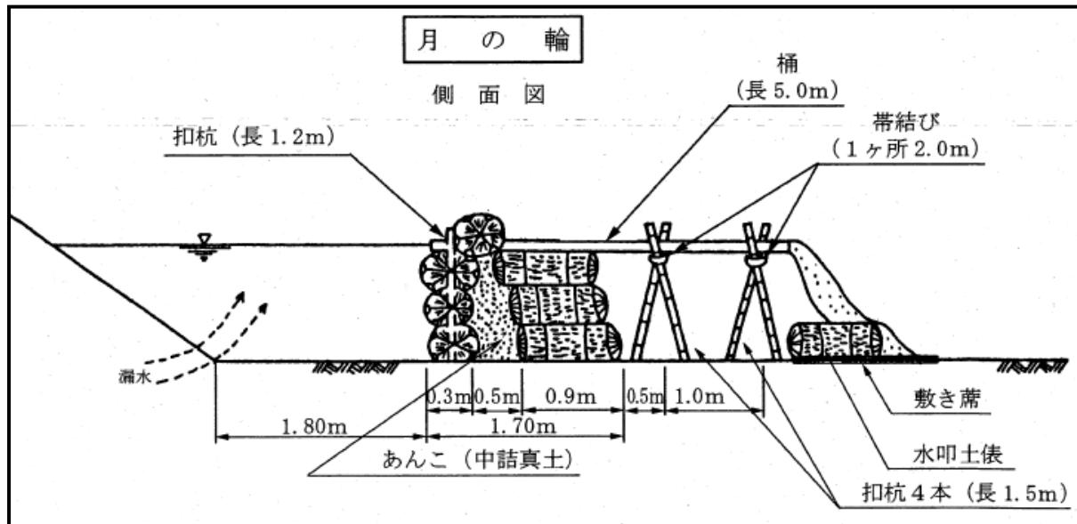
目的：川裏の漏水を堰き上げて滲透水の圧力を弱める。
