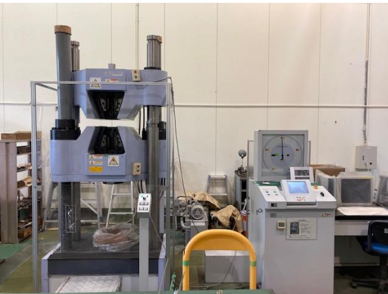
万能材料試験機（工業技術センター）
