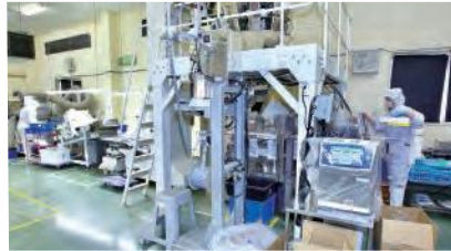
機械を使ってイリコを袋詰めする工程で、 異物混入などを人の目でもチェック
