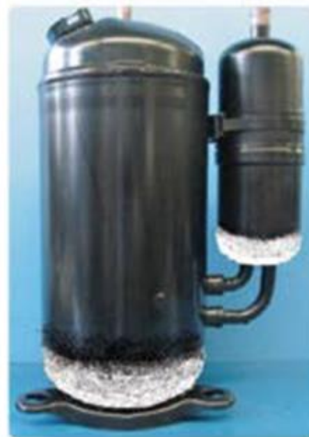
【圧縮機及び アキュムレーター底部の霜付き】
