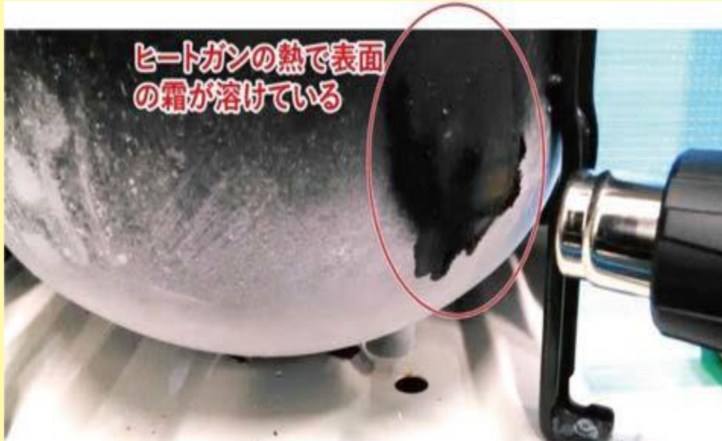
アキュムレーターの霜付きにヒートガンを当てている様子
