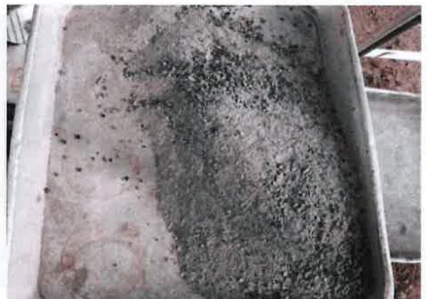
木質ペレットの燃焼灰
