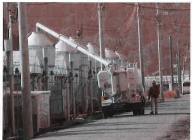
貯蔵タンクへの燃料の投入
