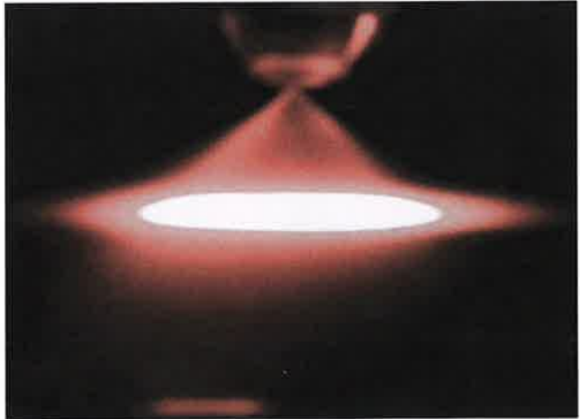
正常な噴霧パターン
