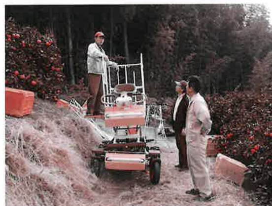
高所作業台車による収穫作業の省力化
