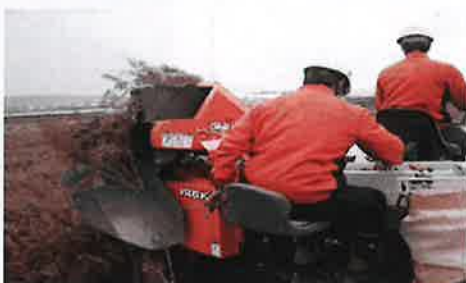
フレコン式にんじん収穫機:イセキ機械カタログより
