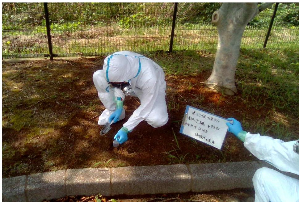
線量測定・試料採取実動訓練
