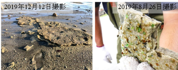
図 2b 大村における覆砂区の状況 大村の覆砂区で見られる板状の固化体 (左)。固化体中には再生砂の原料であるガラス片が含まれる (右)。
