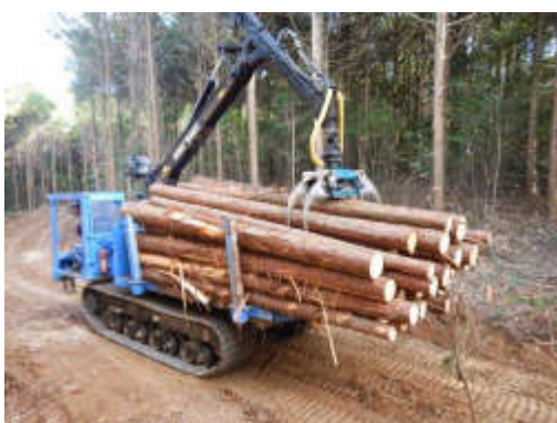
県営林内における高性能林業機械・フォワーダの稼動 （西海市大瀬戸町 県営林万助山団地）
