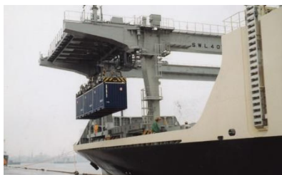
【ガントリークレーン】
