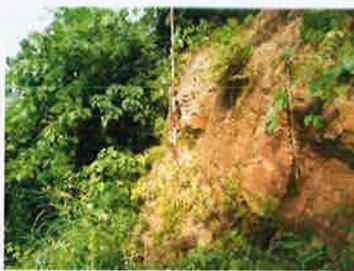
頭部滑落崖に露出する泥質砂岩崩壊により基岩が露出する
