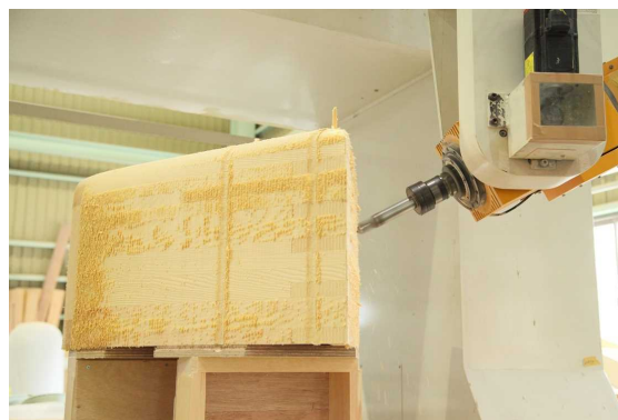
3D ものづくりに対応した大型 5 軸加工機
