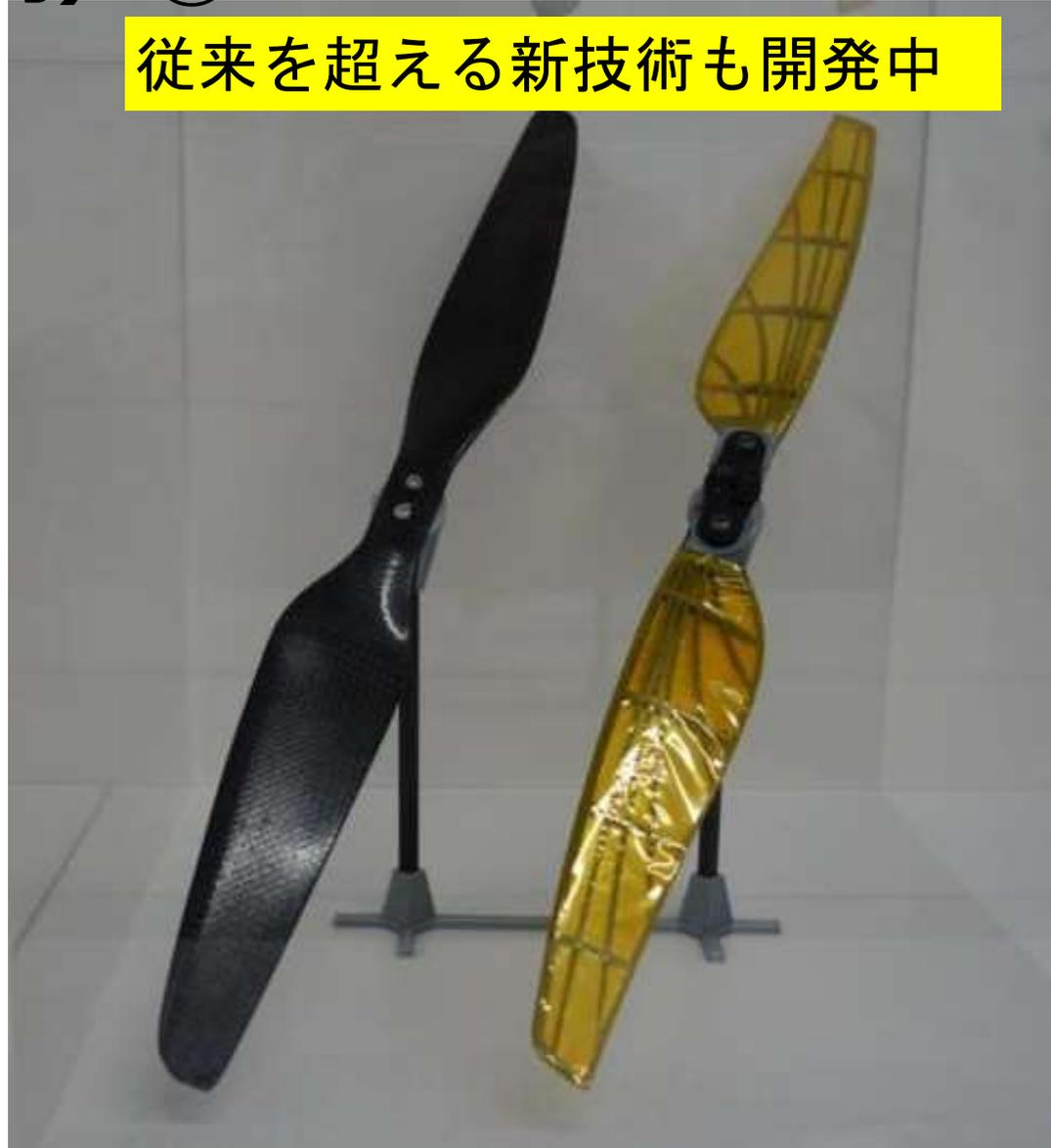
トンボの羽を規範に開発した柔らかいプロペラ（右）と一般的なドローン用プロペラ
