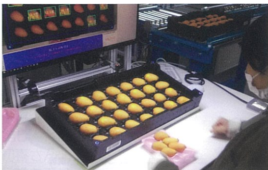
プロジェクトマッピングを使った選果 （※果実に等階級を光で明示）
