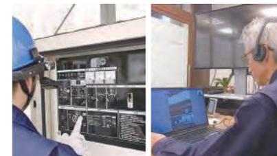
新商品のスマートグラス遠隔保守システム。タブレットやスマートフォンを用いて、遠隔地からでもサポートを行う事ができる
