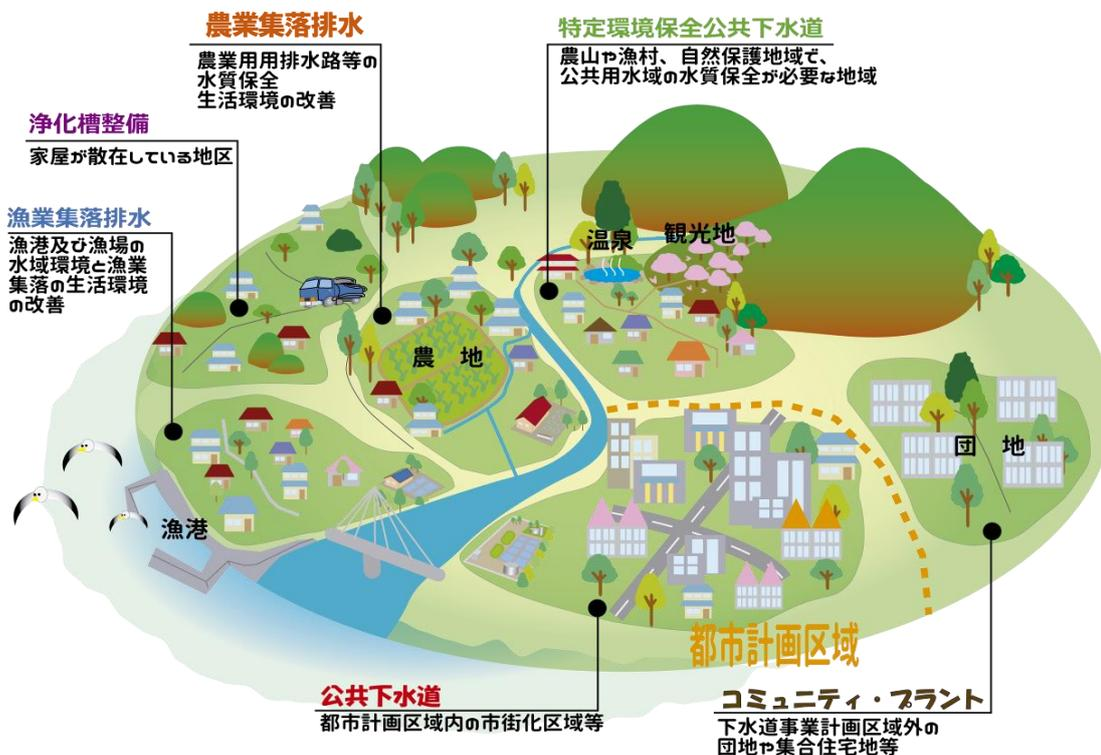
図4-2 汚水処理と水循環(出典：長崎県汚水処理構想2017)
