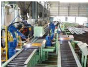
自動鋼材溶断ロボット開発テスト
