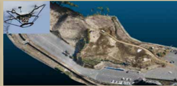
ドローン等による3次元測量
