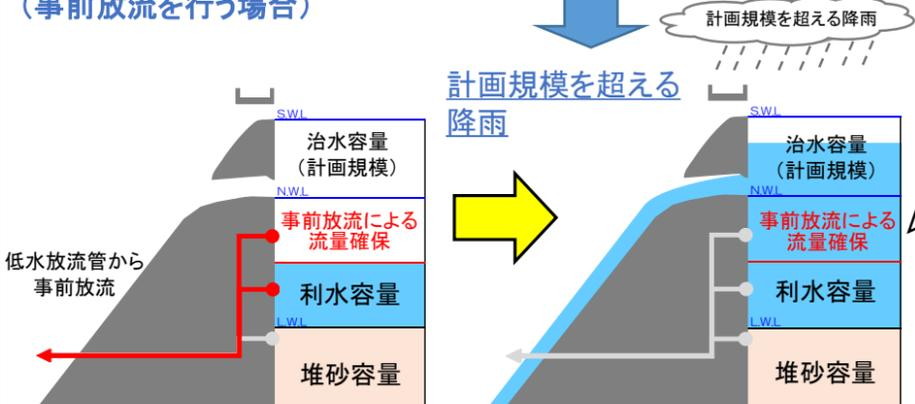
事前放流を行い、利水容量を低下させ、洪水調節容量を増やすことで、計画規模以上の降雨に対しても洪水調節機能を発揮し、被害の軽減を図ることができます。
