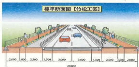
池田沖田線【竹松工区】 標準断面図
