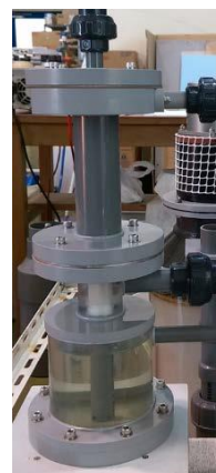
図1 新規電解槽外観
