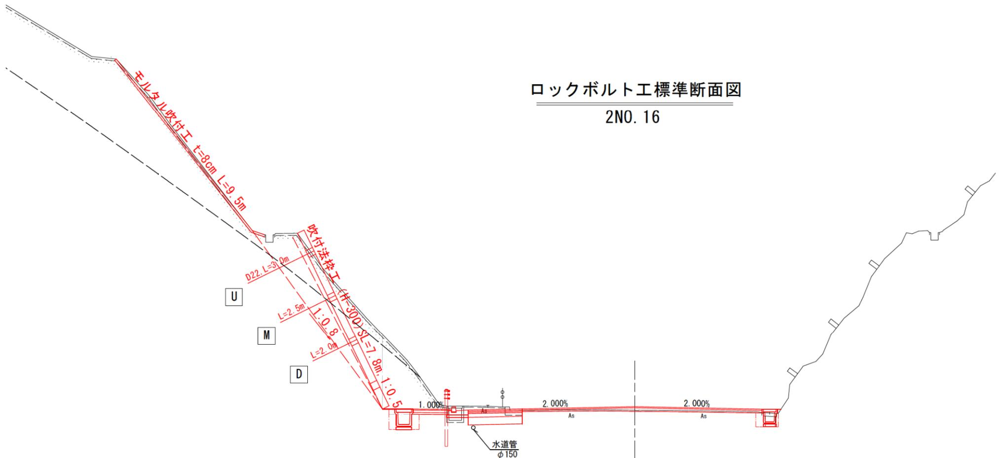
新長崎漁港に向かって、左側斜面の1段目の掘削及び、2段目の補強工事を行います。
