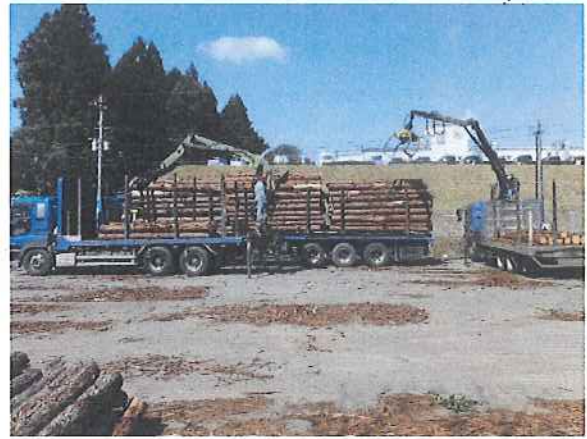
グラップルトラックによる丸太運搬状況
