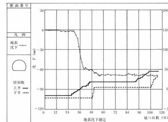
図-10 地表沈下測定(例)
