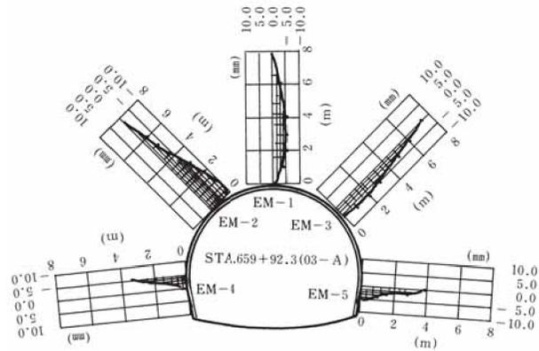
図-14 地中変位の断面分布図(例)
