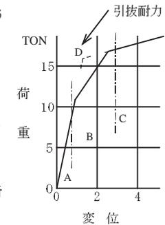
図-27 ロックボルト引抜き試験
