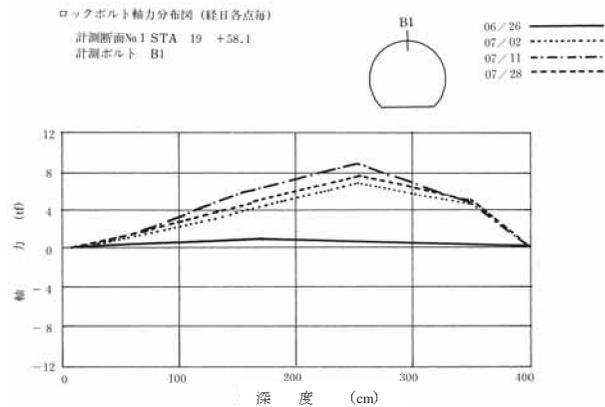
図-18 ロックボルト軸力分布図(例)
