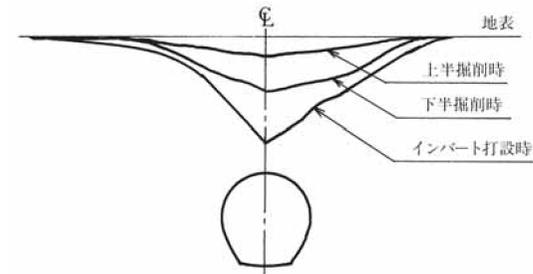
図-24 地表沈下分布図
