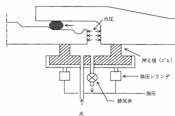
図-3 テストバンドの機構の概略
