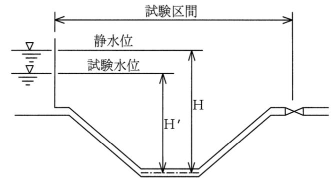
図 - 4 試験水頭のとり方
