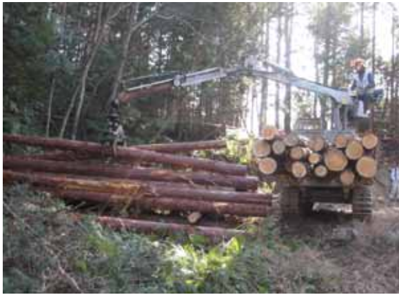
フォワーダによる搬出作業
