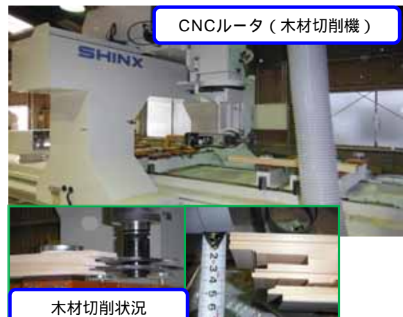
県産材の需要拡大に向けた木製サッシの作成 (高性能木材加工機による切込作業)
