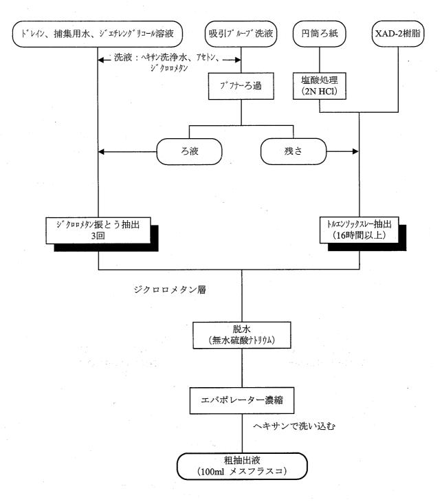
図 3-2 煙道排ガスの抽出分析フロー
