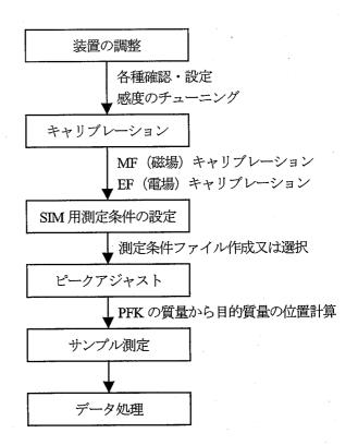
図5 GC/MS 測定の流れ
