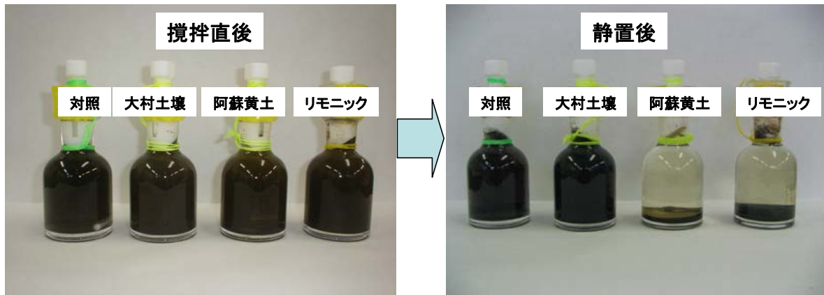
写真1 硫化物イオン捕捉能力試験結果(人工黒色水)
