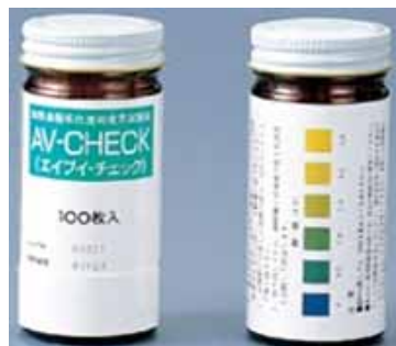
図 3-5 市販されている加熱油脂劣化度判定試験紙 （株式会社Jオイルミルズ製）
