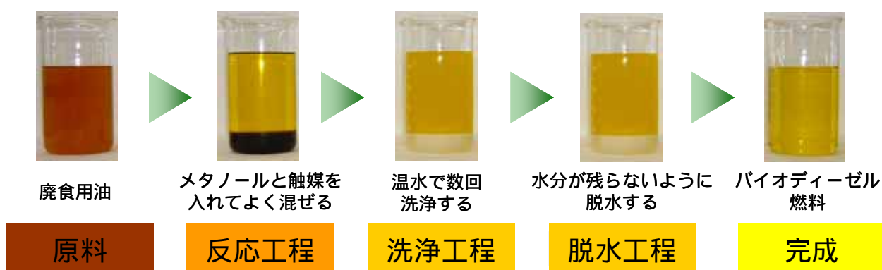
図 3-3 バイオディーゼル燃料の一般的な製造工程
