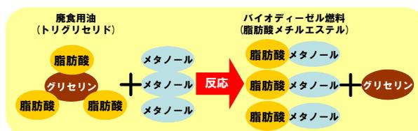
図 2 バイオディーゼル燃料の生成反応
