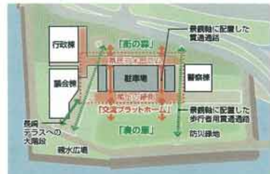
図2.7 1階平面計画の考え方
