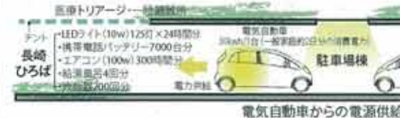
電気自動車からの電源供給
