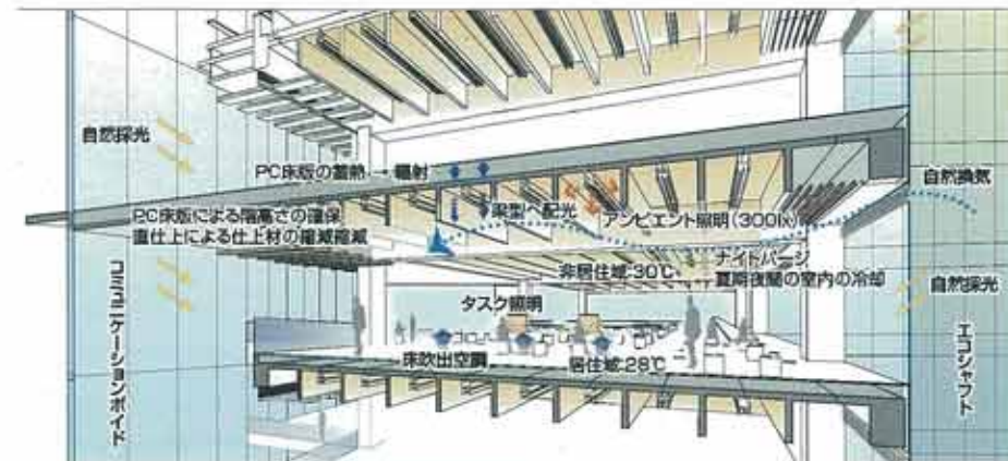
図 4.6 長寿命化とLCCに配慮した庁舎執務階断面概念図
