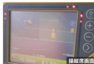
ICT建設機器による半自動施工
