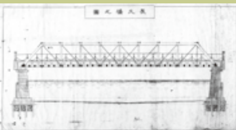
長久橋（ブラットラス形式、木鉄混交橋、明治22年（1889）架設）（個人蔵）
