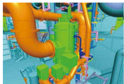
点群データからモデリングした配管形状
