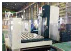
横中ぐり機（大村工場）
