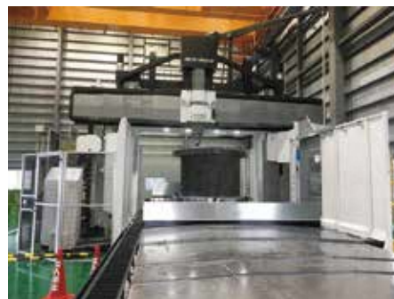
五面加工門型マシニングセンタ加工風景
