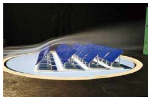
浮体式太陽光発電の風圧実験
