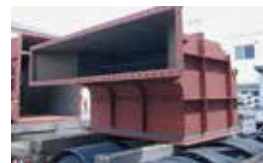
排気ガスダクト
