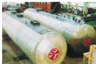
30KL SF2重殻地下タンク
