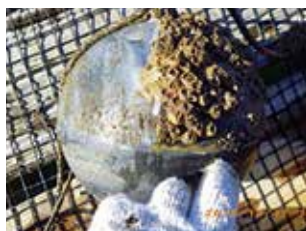
PEフロート 防汚塗装3ヵ月後
