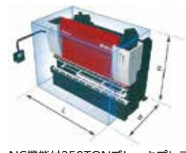
NC機能付350TONプレーキプレス（時津工場）
