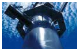
デッキクレーン踊場
