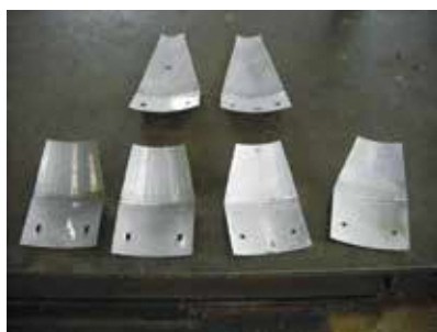
製缶 SUS 曲げ加工+溶接 ブラケット
